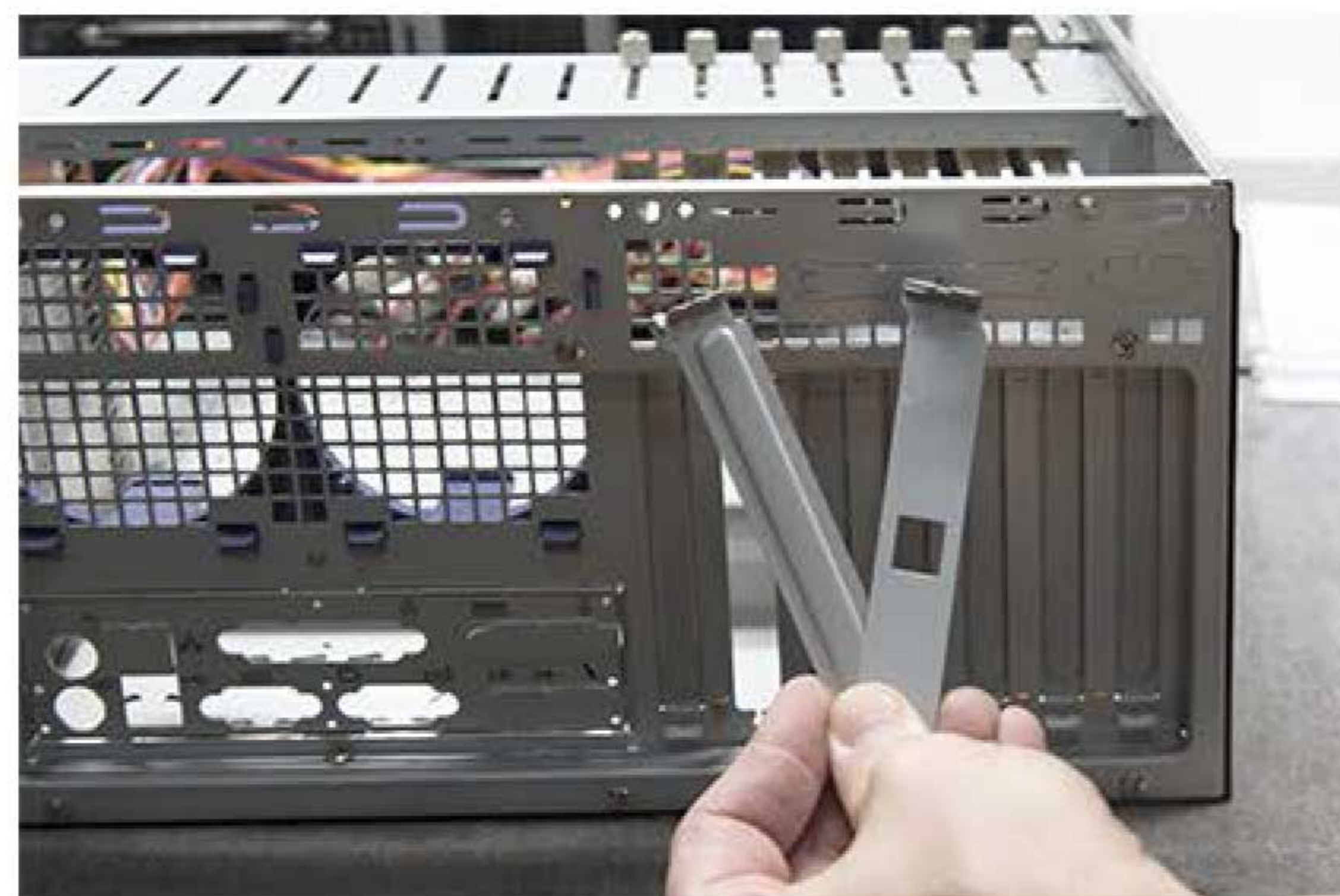
8. Wymień standardową zaślepkę PCI na zaślepkę z otworem na przycisk resetu.
