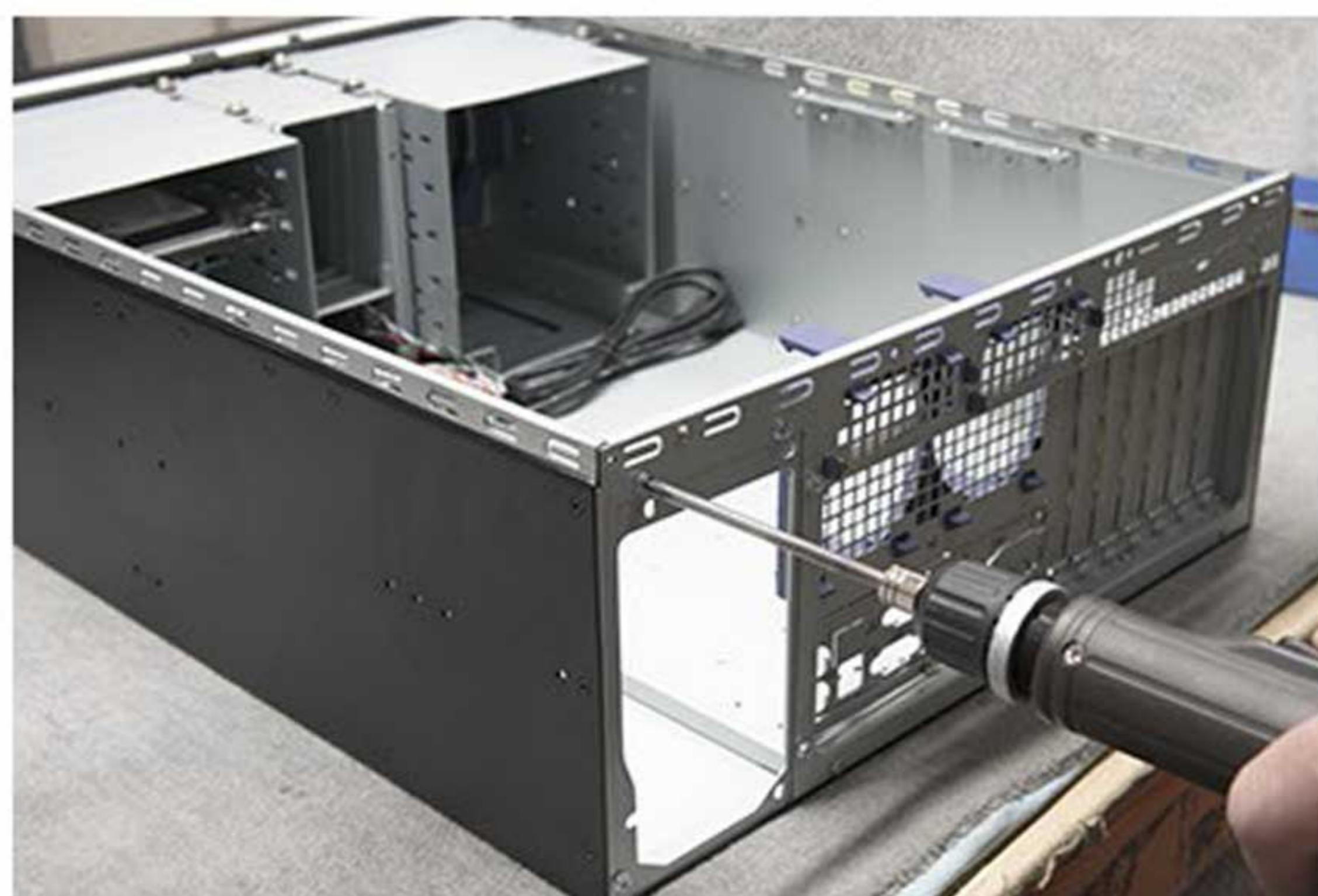
4. Wykręć śrubki metalowej ramki zasilacza.
