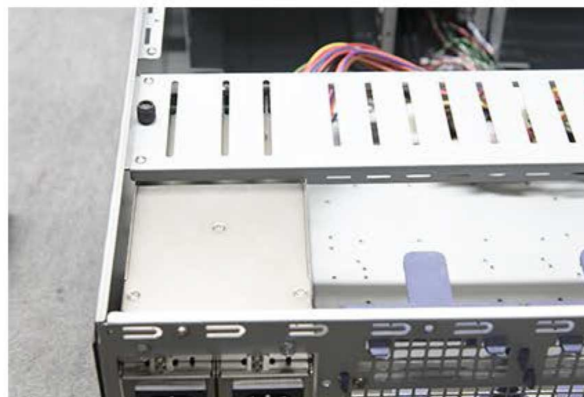
11. Zamontuj klatkę na dyski twarde (HDD).
