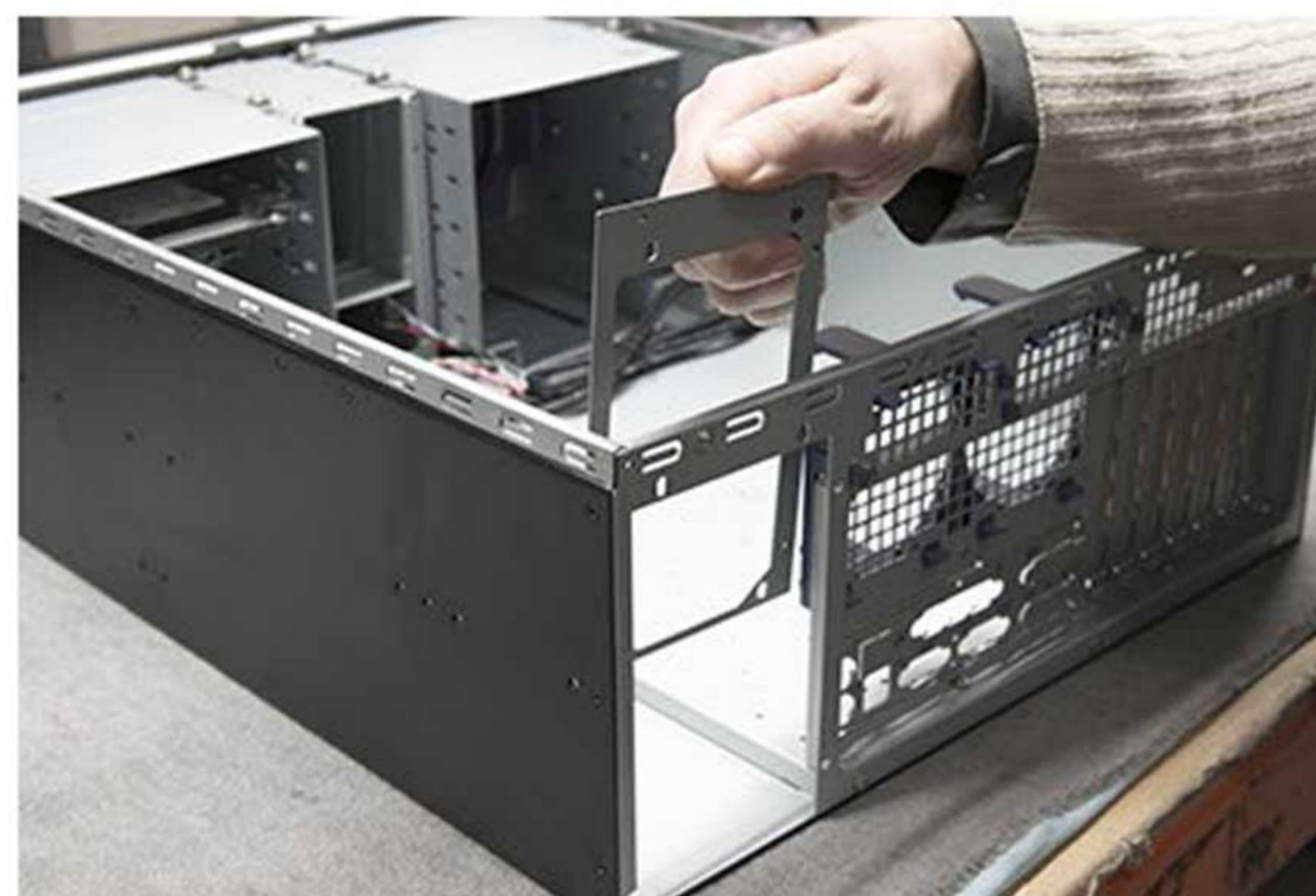
5. Zdemontuj metalową ramkę zasilacza. (Ramka potrzebna tylko przy montażu zasilacza ATX)
