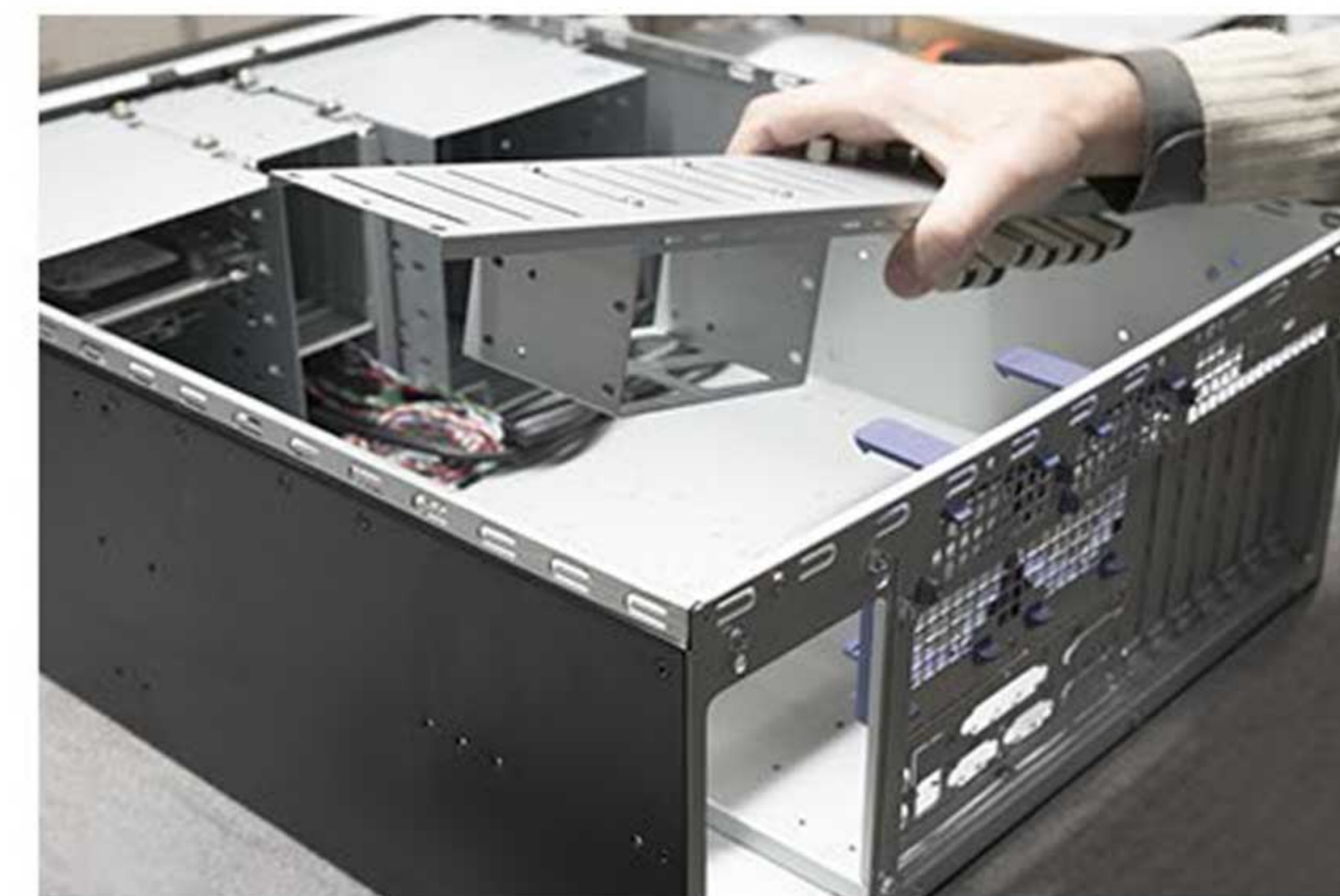
3. Wyjmij klatkę na dyski twarde (HDD).
