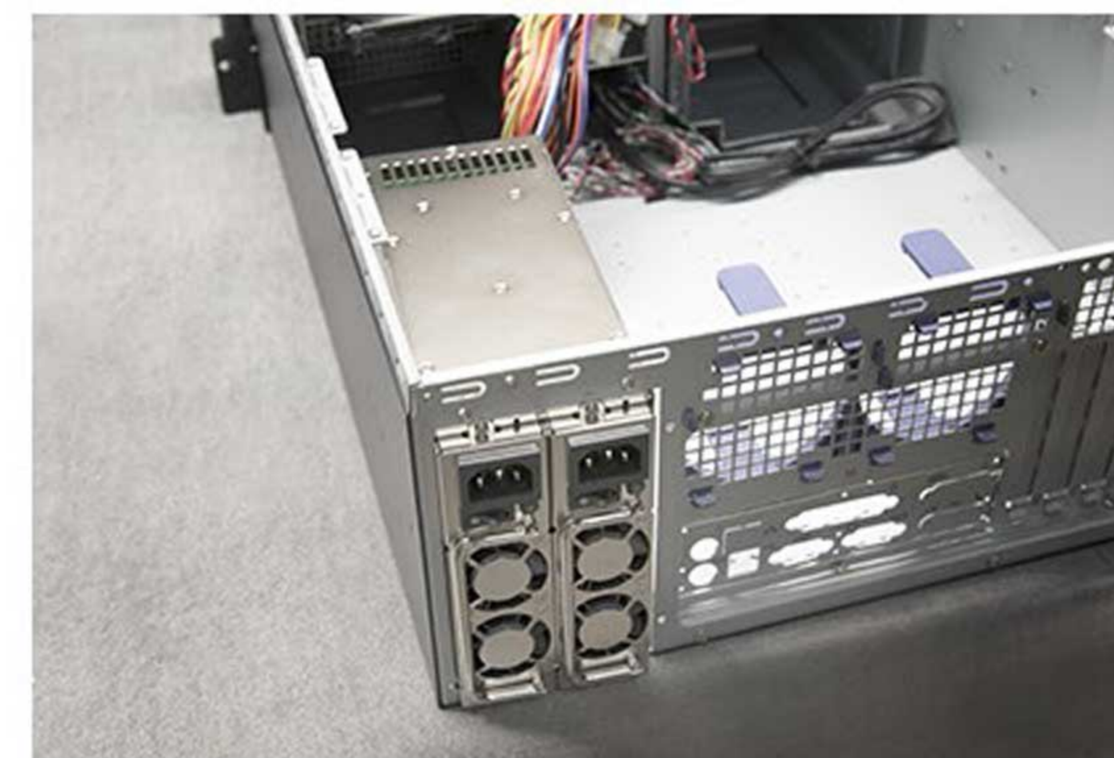
6. Zainstaluj mini-redundantny zasilacz jak pokazano na zdjęciu.
